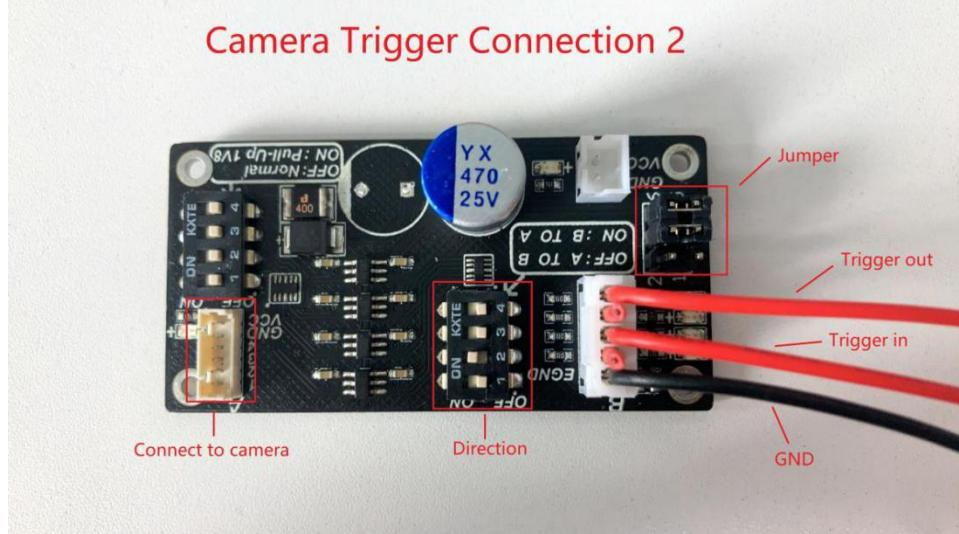
这两种连接方式只有跳线方式不同，Connection1的Trigger Out 电平固定为 5V，Connection2 的 Trigger Out 电平为 1.8V 或 2.5V，QHY4040PRO、QHY600、QHY268、QHY461、QHY411 为 1.8V，QHY4040 为 2.5V。另外需要注意的是，QHY4040 及 QHY4040PRO 由于硬件原因，只能同时使用 Trigger In 或 Trigger Out 中的一个功能。
